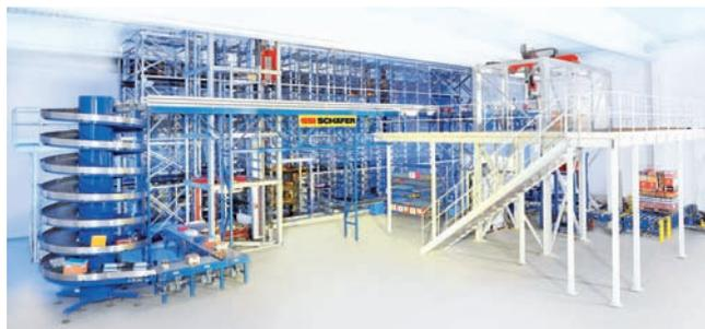
spéciaux en direction de l'installation de stockage automatisée. La gestion des hauteurs de stockage permet d'obtenir une densité de stockage maximale et des accès automatiques uniques ou multiples en un seul mouvement de stock. Le logiciel de palettisation calcule le rangement de la marchandise sur les palettes selon une méthode qui prend en compte l'optimisation du volume, la stabilité et la fragilité des produits. « SSI Schaefer
