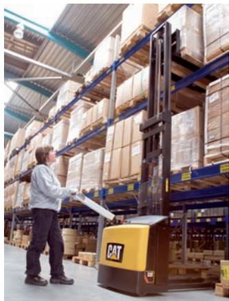
Le transpalette électrique porté NPP20N de Cat Lift Trucks distribué par Aprolis est équipé en série d'un indicateur de sens de marche, d'un horamètre, d'un indicateur de charge batterie et d'une disposition ergonomique des commandes.
