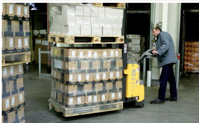
Le gerbeur électrique accompagnant compact Doppio d'Atlet est utilisé pour la manutention simultanée de deux palettes à la fois. Il possède un timon avec panneau de commandes intégré et un code d'identification cariste. L'ordinateur de bord permet le paramétrage du chariot et facilite le diagnostic en cas de panne. Il est disponible en deux versions : 1 250 kg et 1 600 kg.
