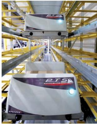
moins. Le PTS qui doit être installé au centre Shimano de Nunspeet – une première mondiale ! – comptera plusieurs allées de stockage équipées de rails reliés aux élévateurs, mais aussi des convoyeurs à bande transportant les produits vers deux zones de préparation de commandes et une zone de réap-
